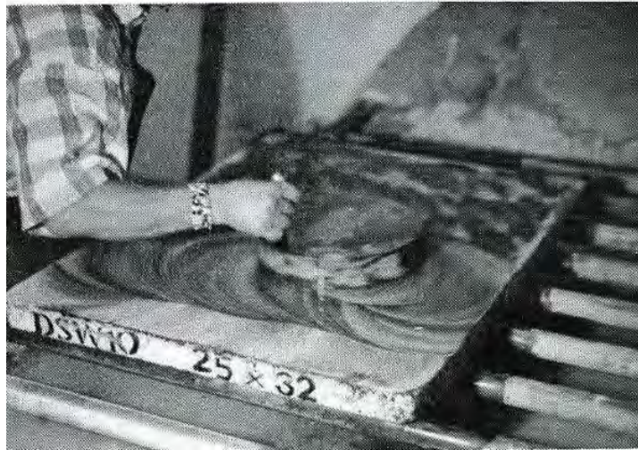
Graneado con Borriquete y grano de Carborundum
